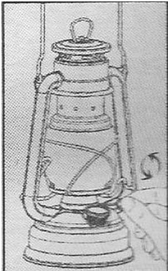
Para acceder a la mecha: Presione el soporte hacia abajo en el lado izquierdo y déjelo enganchar en la muesca. Deje sobresalir la mecha 1,2 mm del quemador, encender con mechero o cerilla.
