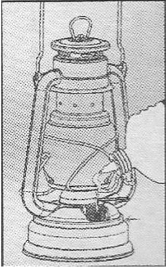
Llenado de combustible: abrir la tapa del combustible y llenar hasta la curvatura sin sobrepasar el tapón. Dejar que la mecha se remoje durante unos 10 minutos. Llène con combustible de petróleo o parafina el depósito.
