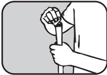
1. Bereiten Sie die Oberfläche vor, indem Sie den Bereich rund um die Bruchstelle säubern. Schleifen Sie glatte Oberflächen an.
