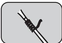
5. Nachdem Sie die Bruchstelle mit Reparaturband umwickelt haben, wickeln Sie den mitgelieferten Vinylstreifen fest über das Reparaturband, um die Lagen anzupressen (das ergibt eine bessere Abdichtung und Optik). Warten Sie dann 15-20 Minuten, damit das Reparaturband vollständig aushärten kann. Ziehen Sie jetzt den schwarzen Vinylstreifen wieder ab.
