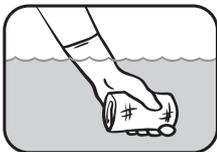
3. Öffnen Sie den Beutel mit dem Reparaturband und tauchen Sie den Inhalt für 10-12 Sekunden in lauwarmes Wasser (Zimmertemperatur).
