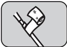
4. Das Reparaturband haftet nicht in gleicher Weise wie übliche Klebebänder. Wickeln Sie die ersten Lagen vorsichtig direkt über die Bruchstelle herum, damit sie nicht abgleiten. Die nachfolgenden Lagen sollten fester gewickelt werden. Verwenden Sie die ganze Rolle Reparaturband, damit Sie mindestens sechs Lagen über die Bruchstelle wickeln können und an beiden Seiten der Bruchstelle 5-10 cm als Halt vorhanden sind.
